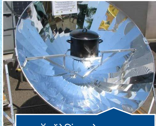
कॉन्सेंट्रेटिंग सोलर कुकर ( >100^{\circ}\text{C} ) (उदाहरण के लिए: परवल्यिक डिश)
